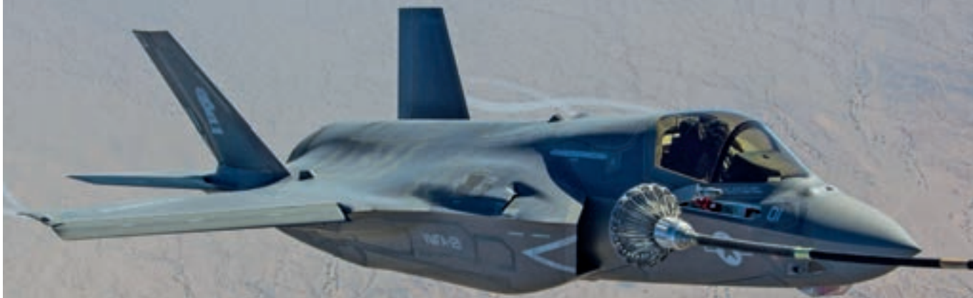
Дозаправка топливом в воздухе самолета F-35B из состава 121-й истребительно-штурмовой эскадрильи Корпуса морской пехоты США
